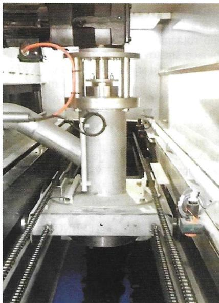
Obr. 4: Distributor odvodněného kalu s řezacím nožem na sušicí pás („nudličkovač“)
