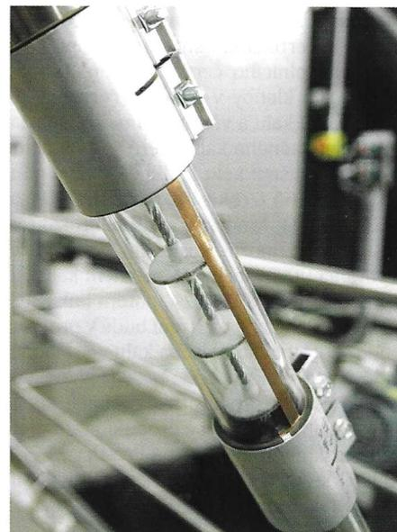
Obr. 5: Diskový trubkový dopravník granulovaného sušeného kalu do kontejnerů
