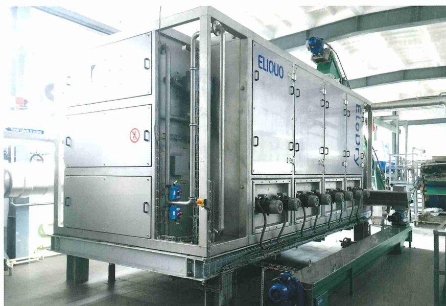
Obr. 3: Nizkoteplotní nekondenzační vzduchem chlazená sušárna ELIQUO EloDry NT16
