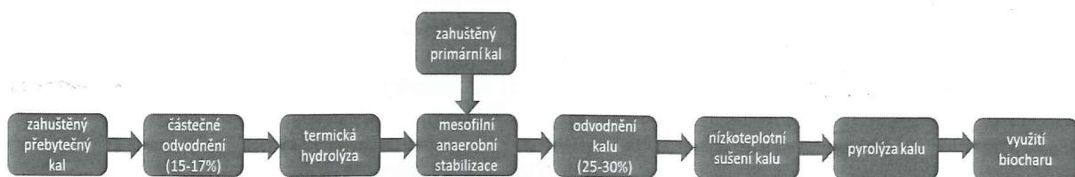
**Obr. 3 – Příklad skladby kalového hospodářství ČOV s termickými a termochemickými procesy**
