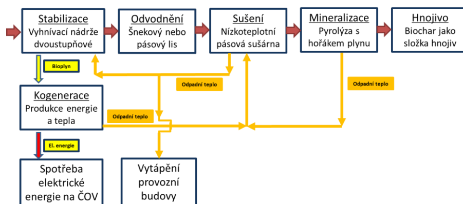
Obr. 4: Schéma kalového hospodářství ČOV s využitím tepelné energie z kogenerace a pyrolýzy (interní hořák plynu) pro sušení kalu a vytápění
