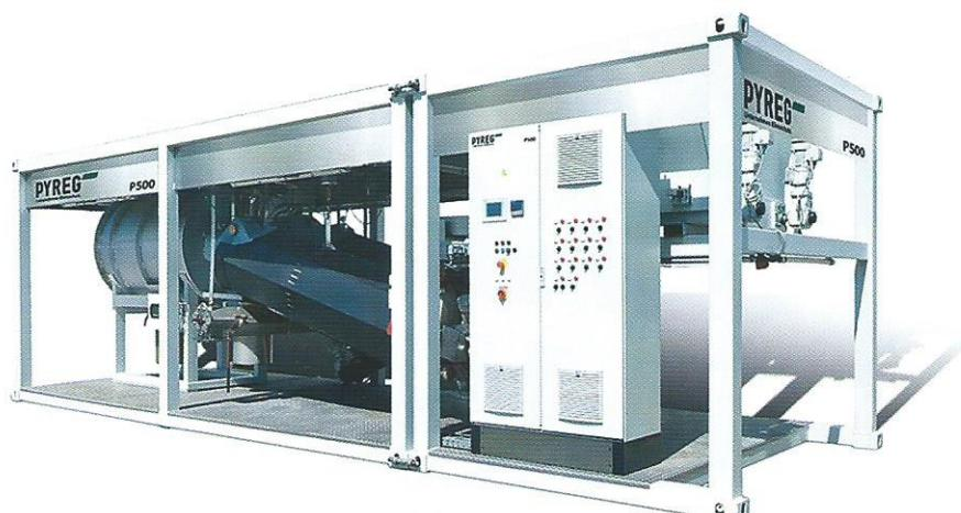
Obr. 9: Pyrolyzní stanice PYREG® pro zpracování kalu na biochar s reaktorem FLOX® pro spalování vznikajícího pyrolyzního plynu (zdroj [www.pyreg.de](http://www.pyreg.de))
