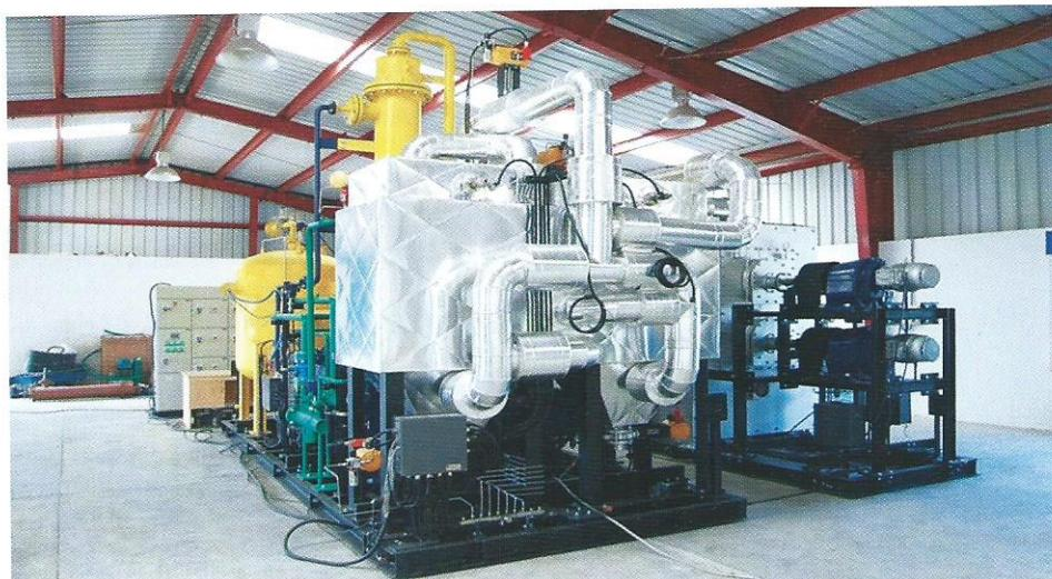
Obr. 3: Pyrolýzní jednotka M3RP (poskytnuto Thersion a. s.)
